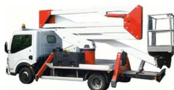
Catégorie 1B : PEMP dont la translation n'est admise qu'avec la plate-forme de travail en position de transport avec élévation multidirectionnelle.
