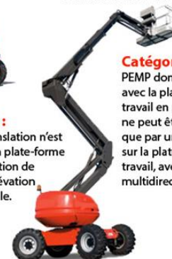
Catégorie 3A : PEMP dont la translation avec la plate-forme de travail en position haute ne peut être commandée que par un organe situé sur la plate-forme de travail avec élévation suivant un axe vertical.
