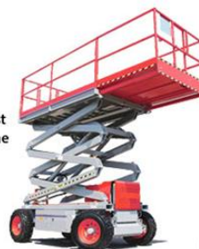
Catégorie 1B : PEMP dont la translation n'est admise qu'avec la plate-forme de travail en position de transport avec élévation multidirectionnelle.
